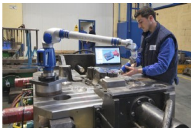
Metrología 3D con brazo FARO – mantenimiento molde OIL PAN
